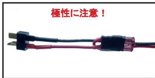
33. ヒューズの周りを黒い大きな収縮チューブで覆い、黒線と赤線にT型コネクタをはんだ付けします。
