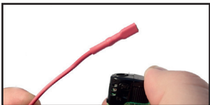
32. ライターまたはヒートガンで収縮チューブを縮め、端子を保護してヒューズを取り付けます。
