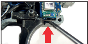
18. トリガースプリングをドライバーやペンチの先でそっと押し込みます。
