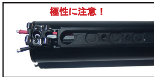
29. 純正バッテリーを使う場合は、ここで配線をカットして端子にはんだ付けします。
