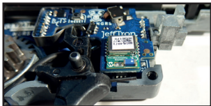
17. 慎重にトリガーをギアボックスに装着します。トリガースプリングはギアボックスの外に出してください。
