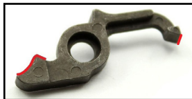
Obr. 4 - pokud je ramínko moc vysoko, zbruste ho na označeném místě
