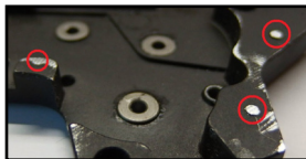
Obr. 6 - při tlusté kabeláži zbruste výstupky na mechaboxu
