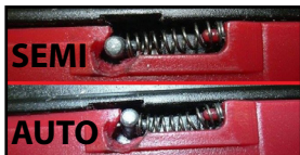
Obr. 3 - úprava kulisy přepínače, když to střílí automaticky místo semi
