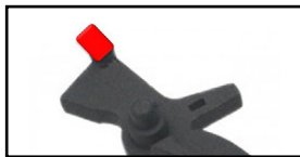
Obr. 5 - zbroušení spouště aby nepoškodila mikrosplínáč
