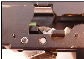
Obr. 6 - správné sepnutí mikrospínače při plném stisku spouště
