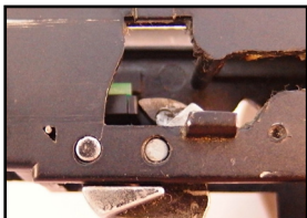
Obr. 6 - správné sepnutí mikrospínače při plném stisku spouště
